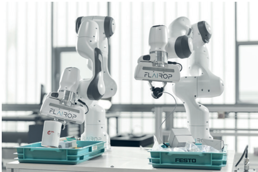
Flairop-Kommissionierroboter trainieren, um verschiedene neue Artikel greifen zu können.
