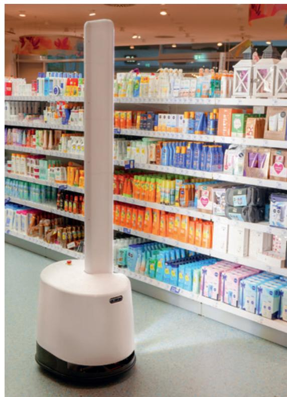
Der Ubica-Roboter zeichnet den Aufbau der Filiale, den exakten Standort der Produkte und den Warenbestand auf. Foto: Ubica Robotics.
