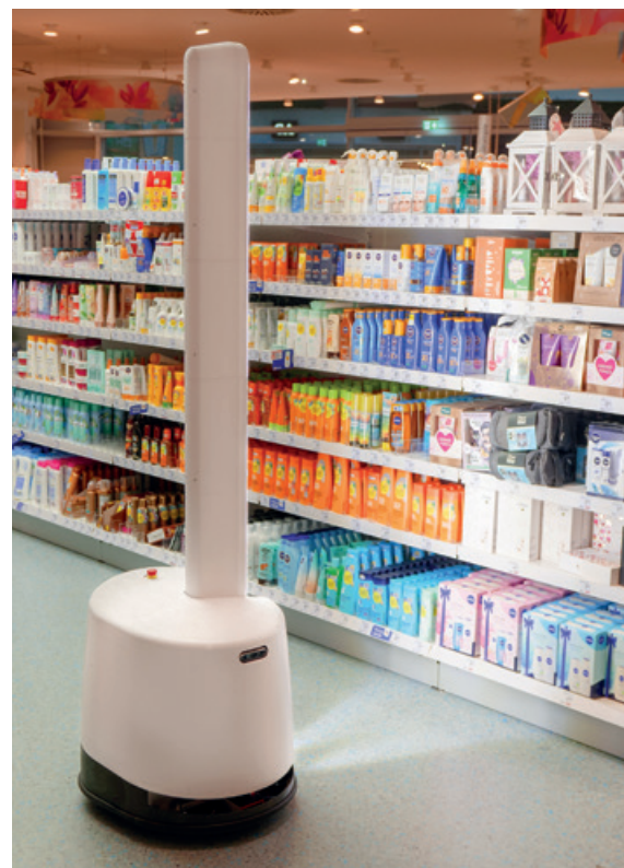
Der Ubica-Roboter zeichnet den Aufbau der Filiale, den exakten Standort der Produkte und den Warenbestand auf. Foto: Ubica Robotics.
