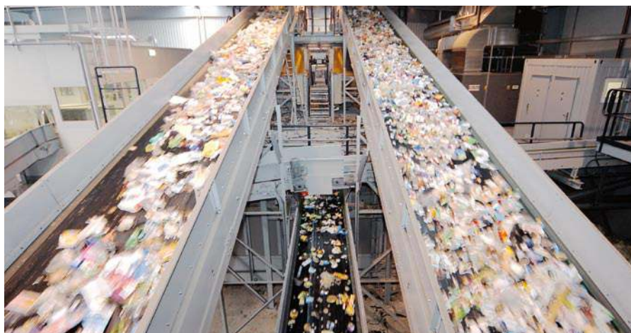
In Alba-Sortierungsanlagen werden u. a. Leichtverpackungen aus den Sammlungen der dualen Systeme getrennt.
