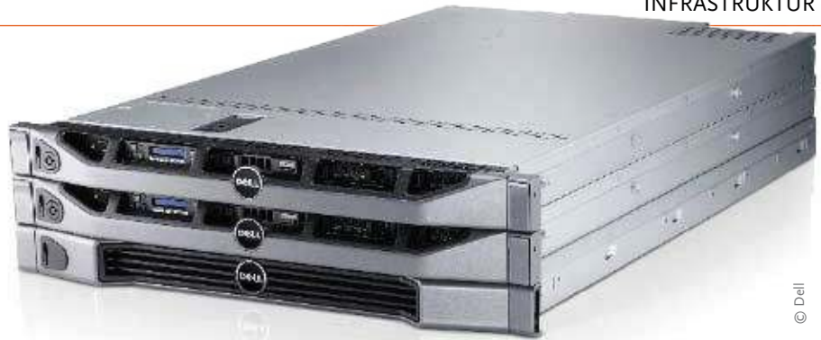
Das Storage Array Dell EqualLogic FS7500 nutzt das Scalable-File-System, das über zahlreiche erweiterte Funktionen wie Cache Monitoring, Load Balancing und Multi-Threading für schnelle I/O-Berechnungen verfügt.
